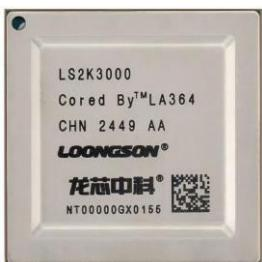
龙芯2K3000是一款通用8核SoC芯片，面向工控应用领域。采用龙芯自主指令系统（龙架构），基于自主研制的LA364E处理器核，SPEC CPU 2006 Base单线程定/浮点峰值性能均超过10分/GHz，与龙芯3A5000处理器使用的LA464核性能相当；集成第二代自研GPGPU核心LG200，图形性能成倍提升，支持通用计算和AI加速；集成丰富的I/O接口，可广泛应用于各种场景。（详细信息：<https://www.loongson.cn/product/show?id=39>）
