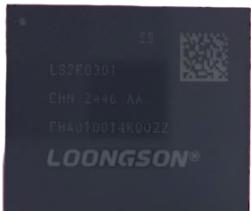
LS2K0301 芯片是一款基于 LA264 处理器核的高集成度 SoC 芯片，专为工业控制、物联网、智能设备等场景打造。芯片采用双发射 64 位 LoongArch 架构，主频可达 1.0GHz，配备 32KB L1 Cache 和 512KB L2 Cache，支持高效能与低功耗平衡。片内集成 16 位 DDR4 控制器（合封 4Gb 颗粒，支持 ECC 与硬件调度），并搭载丰富的高速接口：双路 GMAC 千兆网卡、USB2.0 HOST + OTG、DVO 显示（最高 1920×1080@60Hz）、I2S 音频、4 路 SPI/QSPI（支持系统启动）、4 路 I2C、10 路 UART、2 路 SDIO/eMMC（支持启动）、4 路 CAN-FD、8 通道 12 位 ADC、4 路 PWM、3 组定时器及 106 路复用 GPIO。此外集成 HPET、RTC、看门狗、温度传感器、动态功耗管理（DFS）和硬件加密引擎（AES/DES/SM2/SM3/SM4），支持 JTAG 调试与灵活的中断路由，满足复杂工控与物联网应用的开发需求。
