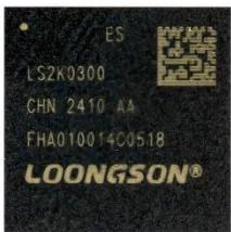
LS2K0300 芯片是一款基于 LA264 处理器核的多功能 SoC 芯片，可广泛适用于工业控制、通信设备、信息家电和物联网等领域。该芯片采用高集成度设计，可提供丰富的功能接口，满足多场景应用需求，同时支持低功耗技术，能够在低能耗条件下进行高效处理。芯片主频 1GHz，片内集成 16 位 DDR4 内存控制器，并集成丰富的外设接口：USB2.0、GMAC、LCD 显示、I2S 音频、高速 SPI/QSPI、ADC、eMMC、SDIO 和其他工控领域常用接口。(详细信息：<https://www.loongson.cn/product/show?id=33>)
