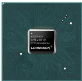
龙芯2K1500内部集成2个LA264核，主频1.0GHz，在接口与功能方面，龙芯2K1500集成了DDR3、PCIE 3.0和SATA 3.0接口，PCIE接口具备RC/EP模式和DMA功能，提供数量丰富的SPI、CAN、I2C、PWM等小接口和USB接口，支持eMMC功能。龙芯2K1500塑封版本采用FC-BGA封装，由于制程工艺的提升和低功耗设计方法的运用，其典型工作场景下功耗低于2.8W，可有效满足低功耗场景下的工控需求。（详细信息：<https://www.loongson.cn/product/show?id=19>）
